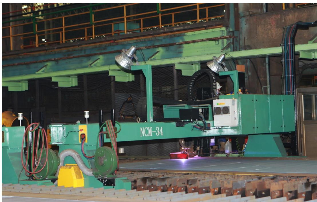
圖說：開工鋼板割切
